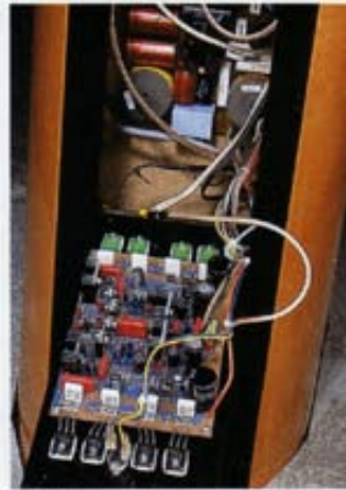
Rank und schlank: Trotz ihrer gigantischen Abmessungen erscheint die neue Titan nicht klobig (links). Hinter Gittern: Hochtemperatur-feste Kaptonfolie des Mitteltöners (Mitte). Power satt: eingebaute MOS-FET-Baßendstufe (rechts).
