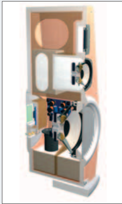
Der Basstreiber ist ins Innere versetzt, das Reflexrohr (grau) zeigt nach unten.
