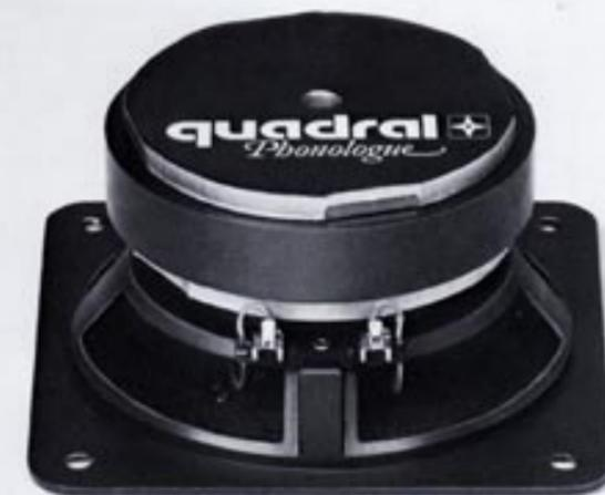
Ein starkes Magnetfeld und eine über den Polkern gezogene Kupferkapsel bewirken in Verbindung mit der geringen dynamischen Masse von 4,4 g die **extrem schnelle Anstiegszeit von 34  $\mu$ s**.
