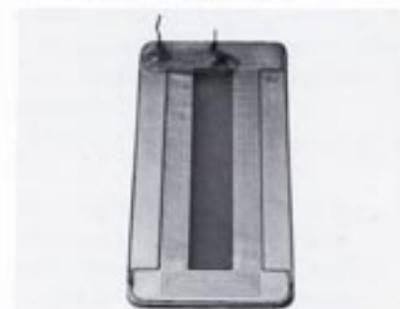
Die effektiv wirksame Membranfläche beträgt ca. 6,3 cm<sup>2</sup> bei einer dynamischen Masse von 0,02 g. (Zum Vergleich: Eine 25 mm Hochtonkalotte hat ebenfalls  $\approx$  6 cm<sup>2</sup> Fläche, aber eine dynamische Masse von  $\approx$  0,7–1 g.) Da alleine die Strahlungsimpedanz für die Bedämpfung der Membran verantwortlich ist, ergibt sich in Verbindung mit der sehr kleinen Masse ein hervorragendes Impulsverhalten, sowie die extrem schnelle Anstiegszeit von 1,4  $\mu$ s.
